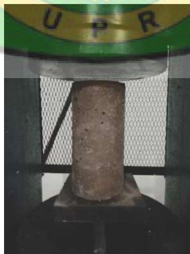
Gambar 3.11. Pengujian Kuat Tekan Beton
