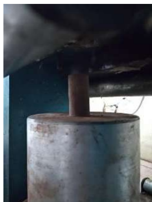
Gambar 3.10. Pengujian Kuat Tekan Pasta Geopolimer
